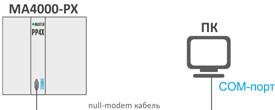
Рисунок 16 – Подключение узла доступа к компьютеру через COM-порт
