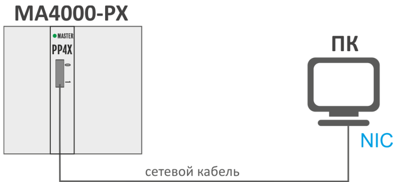
Рисунок 17 – Подключение узла доступа к компьютеру сетевым кабелем
