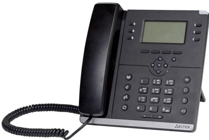
**VP-17P** — современный IP-телефон с интегрированным гигабитным коммутатором, наличие которого позволяет подключить ПК и IP-телефон пользователя по одной физической линии. Устройство обладает передовым функционалом, имеет поддержку технологии PoE, высокое качество и универсальный дизайн.
