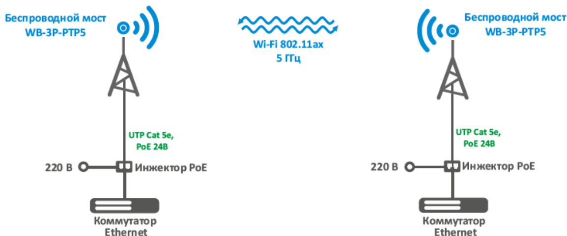
Рисунок 34 — Схема применения WB-3P-PTP5
