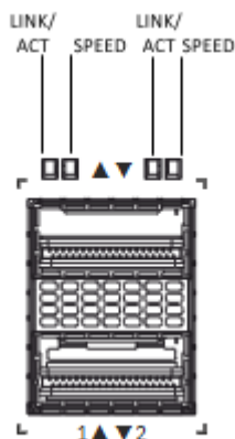
Рисунок 26 — Внешний вид панели индикации интерфейсов QSFP28
