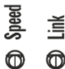
Рисунок 36 — Внешний вид отдельного блока индикаторов SFP
